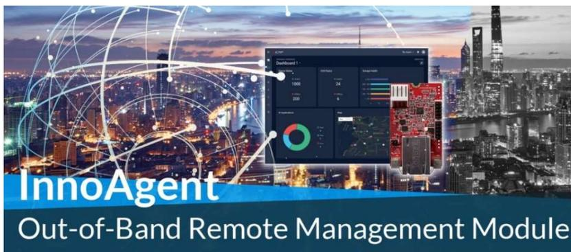
Das Modul bietet 6 programmierbare GPIO Schnittstellen, eine integrierte Heartbeat Funktion und unterstützt Remote Power On/Off und Reset. Als Verbindungsprotokoll wird Standard MQTT verwendet.
